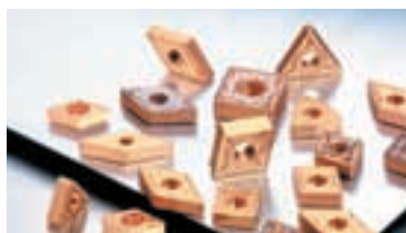
回収された使用済みの切削加工用超硬チップ
