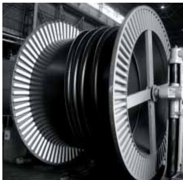
出荷時のYBCOケーブル
